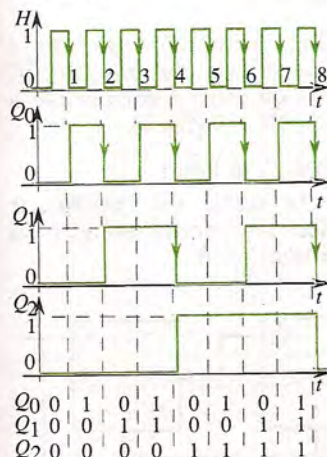
Fig. 6 : Chronogrammes d'un compteur élémentaire modulo 8.
